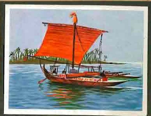
208 Auslegerboot der Südsee . Da die aus einem Baumstamm gehöhlten Boote, bes. wenn sie noch Segel tragen sollen, für die Hochsee-Schifffahrt nicht stabil genug sind, werden sie durch eine Stabbrücke mit einem aus leichtem Holz gefertigten Schwimmer verbunden, um das Umschlagen zu verhindern.
