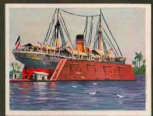
5 Schwimmdock in Dar es Salaam. Das von der Kolonialverwaltung in Dar es Salaam errichtete Schwimmdock ermöglichte es, beschädigte Schiffe auszubessern. Es war 84,5 m lang und hatte eine Tragfähigkeit von 1800 t.
