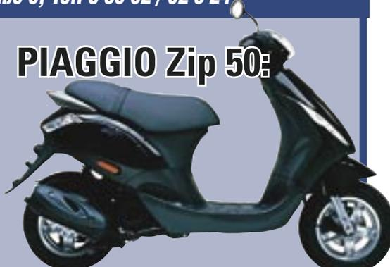
Technische Daten: Motor: 2 Takt, 1 Zylinder, 50 ccm, Leistung: 2,6 kW (3,6 PS) bei 8.500 U/min, Automatikgetriebe, elektrischer Starter, Luftkühlung
